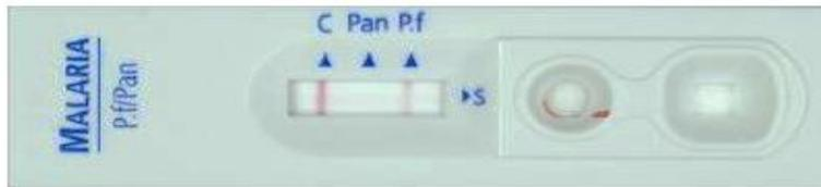
Bien que la ligne colorée horizontale sur "P.f" soit de faible intensité comparativement à celle de "C" ce test est **Positif pour P.f**
