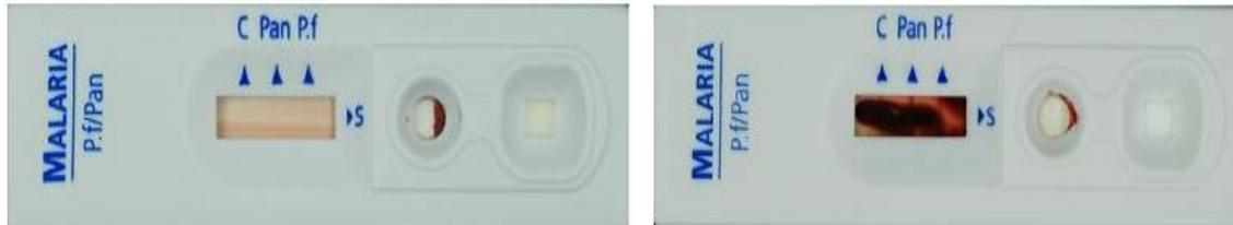
Dans certains cas la fenêtre de résultat est inondée partiellement ou totalement de sang parce qu'on aurait utilisé une grosse goutte de sang (+/- 50 µl) au lieu de juste remplir la boucle de l'applicateur (équivalent de 5 µl prévu). Il faudrait également reprendre le test dans ce cas.
